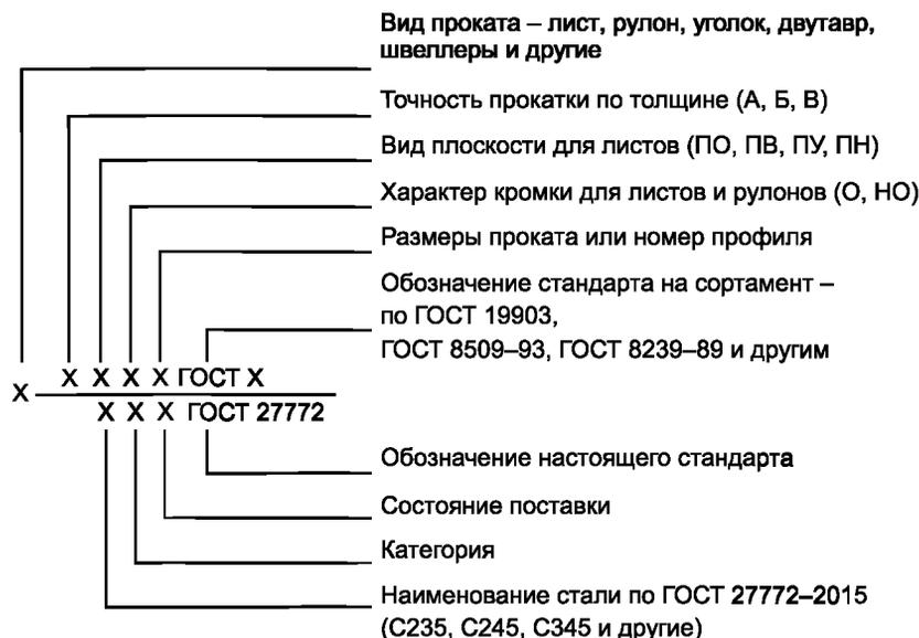
Прокат горячекатаный листовой повышенной точности (А), высокой плоскостности (ПВ), с обрезной кромкой (О), размерами (10×1000×2000) мм по ГОСТ 19903, из стали С390, в улучшенном состоянии (У), категории б:
